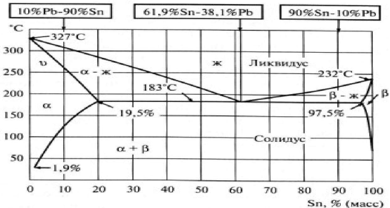
Рис. 1. Диаграмма сплавов олово-свинец
